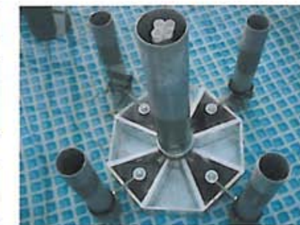
Abb. 5: Modell im Maßstab 1:100 mit Schwimmkörpern für Test des Absenkvorgangs
